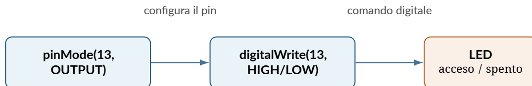
Figura A.14: Un'uscita digitale viene configurata e poi utilizzata per comandare un LED.
