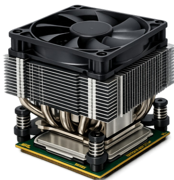
Figura 1.8: Un sistema di raffreddamento ad aria per la CPU, formato da dissipatore metallico e ventola.
