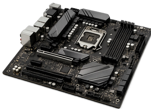
Figura 1.6: Una scheda madre vista dall'alto, con socket della CPU, slot della RAM e connettori per le unità di archiviazione.
