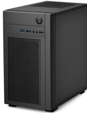
Figura 1.5: Il case contiene, protegge e organizza i componenti interni di un computer desktop.
